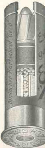
**Ladevorschrift.** Das Geschöß muß unbedingt mit dem am Geschöß fest angeschraubten Filzpfropfen **direkt auf das Pulver** gesetzt werden, da dieser Pfropfen den Ladepfropfen in bester Weise ersetzt. Die Hülse muß dann auch, wie jede gute Schrotpatrone, nach dem Einsetzen des Geschosses ordnungsmäßig geründelt werden.
